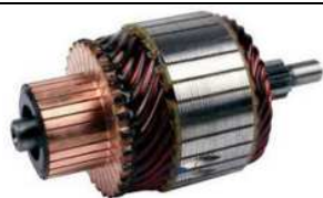
INDUCIDO Tipo MITSUBISHI PEUGEOT - CITROEN L115 x D54 x E9 d25
