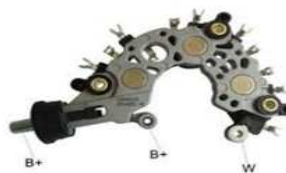
Placa Tipo BOSCH F000BL0700 3 diodos 105 amp. FIAT PÁLIO SIENA STRADA DOBLO
