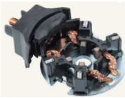
PORTA CARBON Tipo MITSUBA HONDA CRV
