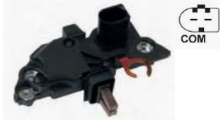
Regulador Tipo BOSCH F00M144151-180-197 AUDI - M. BENZ - VOLKSWAGEN
