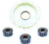
Planetario Tipo MITSUBISHI 42 dientes RENAULT SANDERO DUSTER
