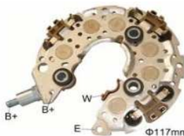
Placa Tipo DENSO DISCOVERI 3.0 RANGE ROVER 12 diodos 117mm. DENSO Nº 104210-3380
