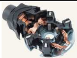
PORTA CARBON Tipo MITSUBA HONDA ACCORD
