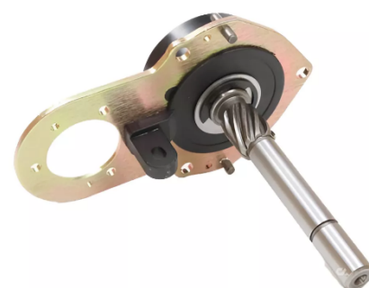
Reductor T. VALEO D6RA 9 Estrias Z59
