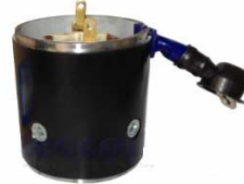
CARCAZA Con CAMPOS Tipo DENSO 24v.5.5kw CATERPILLAR FIAT IVECO STRALLIS 228000-7550
